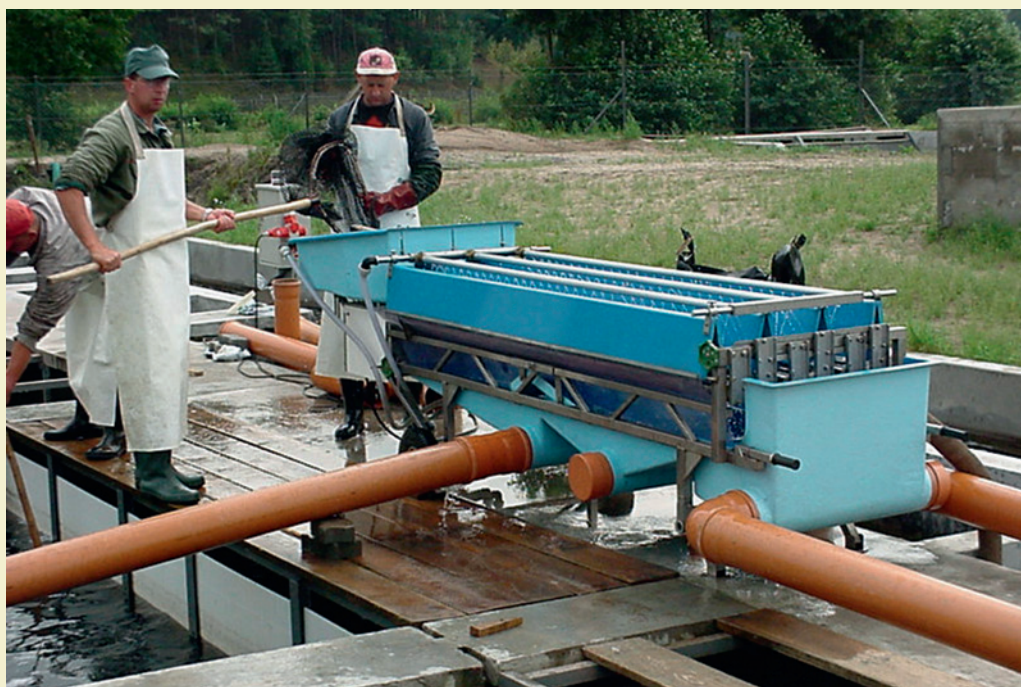
Fot. 10.2. Automatyczna sortownica wykorzystująca pompę wody / Phot. 10.2. Automatic sorting device using water pump
