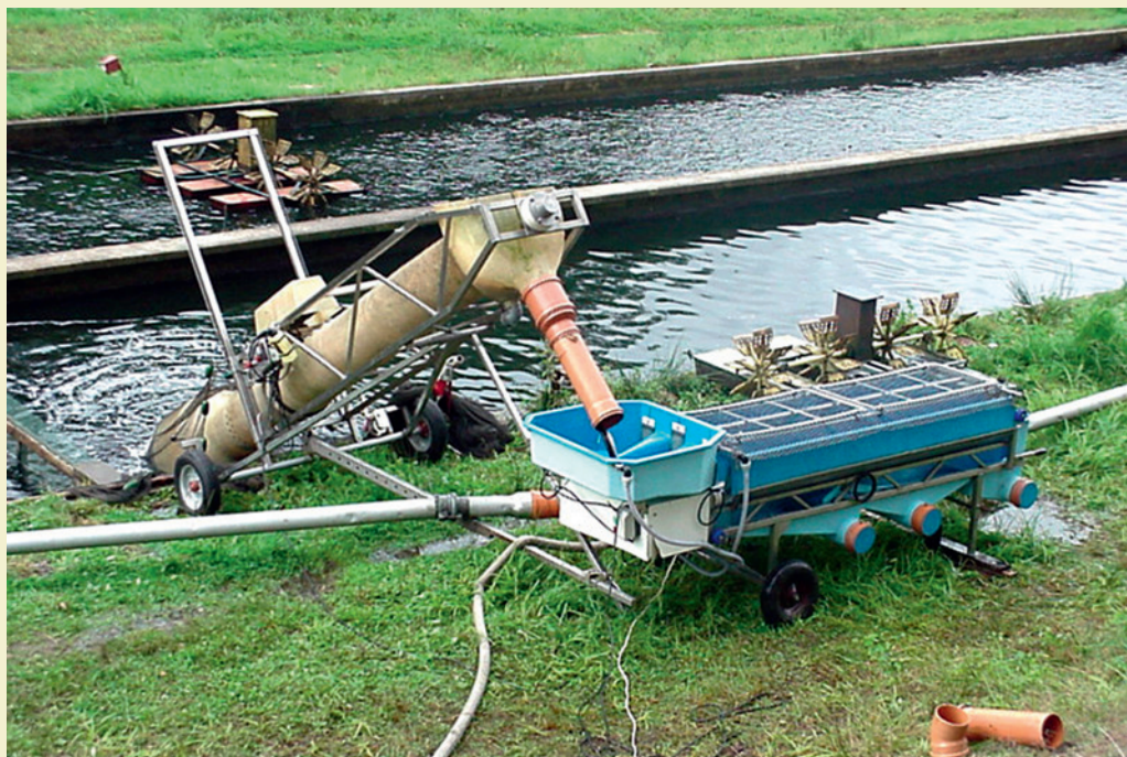
Fot. 10.3. Praktyczne wykorzystanie urządzeń: pompa wody z śrubą Archimedesa i sortownica / Phot. 10.3. Practical use of equipment: water pump with Archimedean screw and sorting device
